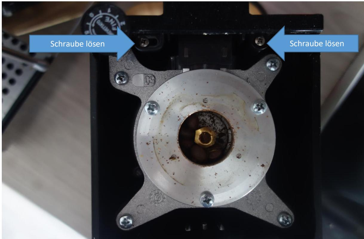
**Teil, in dem die Schraube steckt (Bild 1 ganz oben) entfernen, vordere Abdeckung Vorsichtig nach oben abziehen**
