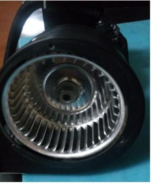
可以用开水加洗衣粉和洗洁精溶剂，用刷子轻微刷洗，并用热水冲洗干净，通电转动风干即可
