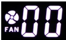
Die Lüftergeschwindigkeit ist in 10 %-Schritten einstellbar, die von 0 (aus) bis 10 (volle Geschwindigkeit) angezeigt werden.
