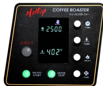
Drehen Sie die Drehknöpfe "TIME" und "TEMP", um die Zielzeit und die Zieltemperatur einzustellen. Die maximalen Parameter sind 25:00 und 412F. Drücken Sie dann ENTER
