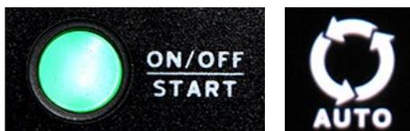
Drücken Sie ON/OFF - START, bis das Symbol "AUTO" leuchtet und damit anzeigt, dass Sie sich im AUTO-Modus befinden. Wenn die Taste ON/OFF nicht leuchtet, drücken Sie noch einmal ON/OFF. Das erste Mal, um sie "aufzuwecken", und das zweite Mal, um sie auszuwählen. Die Taste leuchtet nun auf und zeigt an, dass sie aktiv und auswählbar ist.
